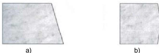
Obr. 30: Chyby keramických obkladových prvkov. a) odchylka pravouhlosti b) odchylka priamosti lícnych hrán
