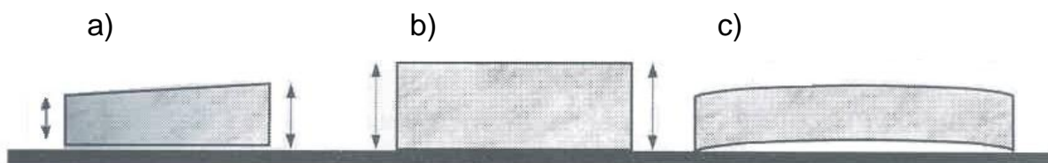
Obr. 29 : Chyby keramických obkladových prvkov. a) odchylka v rohoch , b) odchylka rozmerov, c) odchylka v strede hrany
